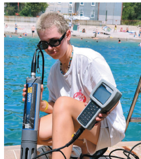
CTD-зонд с логгером — прибор для измерения температуры, электропроводности и давления морской воды
